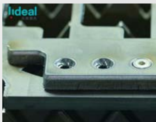
Herstellen von Senkbohrungen (6kW)
