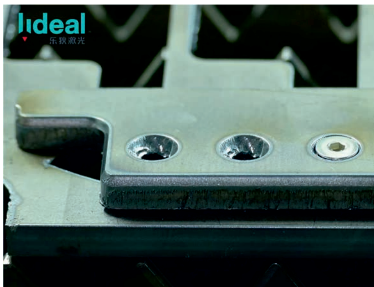
Herstellen von Senkbohrungen (6kW)
